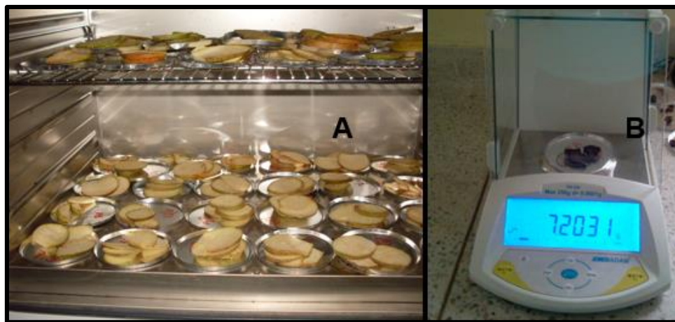
Figura 2-17 Procedimiento para obtener el contenido de humedad, frutos cortados en horno (A) y peso seco (B).
