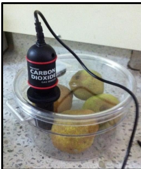
Figura 2-18 Medición de respiración de frutos de pera con sensor de CO 2 (Vernier).
