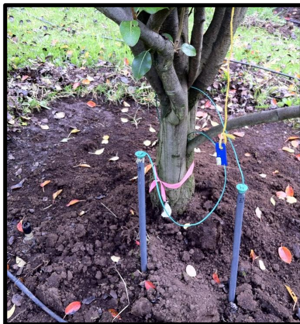
Figura 2-5 Sensor de matriz granular (Watermark).
