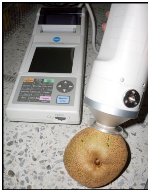
Figura 2-16 Medición de color con el equipo Chromameter CR400 Konica Minolta.
