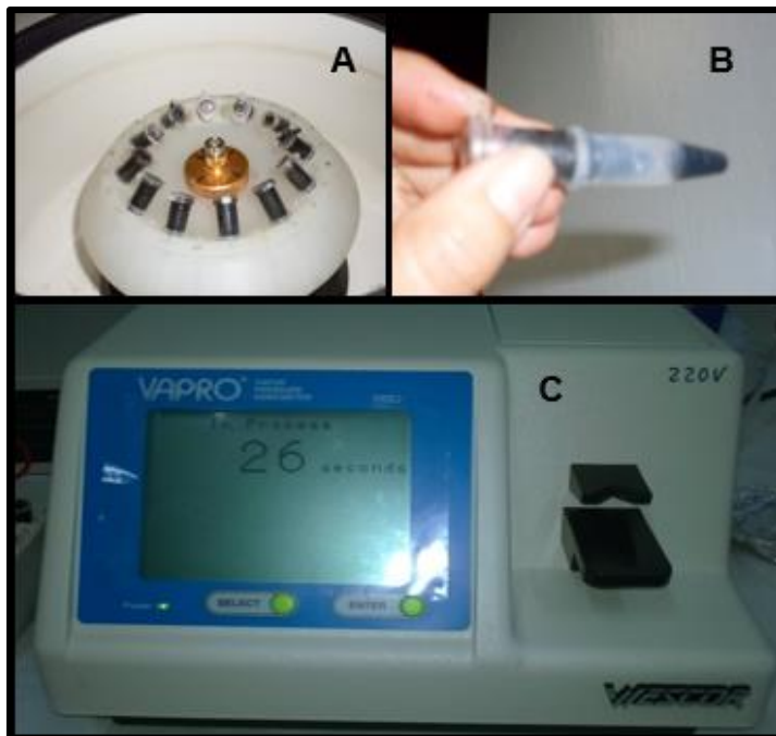
Figura 2-11 Obtención de potencial osmótico saturado, Centrifuga (A), obtención de jugo celular (B), osmómetro(C).
