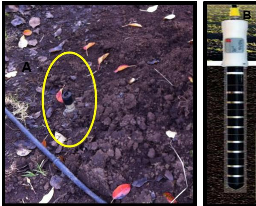
Figura 2-4 Tubo de acceso (A) para medida y sonda de perfil PR2 (B) de la humedad volumétrica del suelo.
