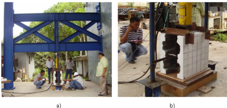
Figura 2. Ensayo de conexiones con lámina plegada perpendicular. a) Vista general del ensayo. b) Detalle del espécimen. Fuente: Elaboración propia.
