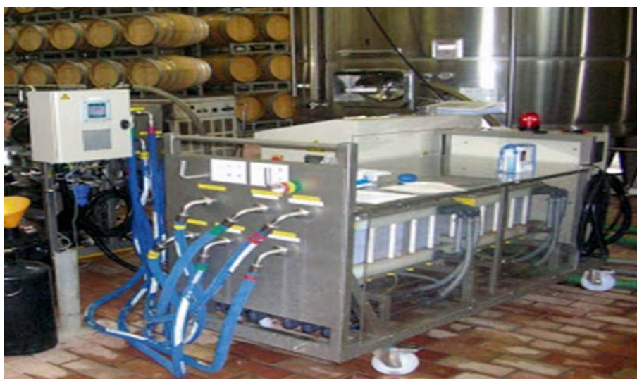
Figura 9. Equipo de Electrodialisis
