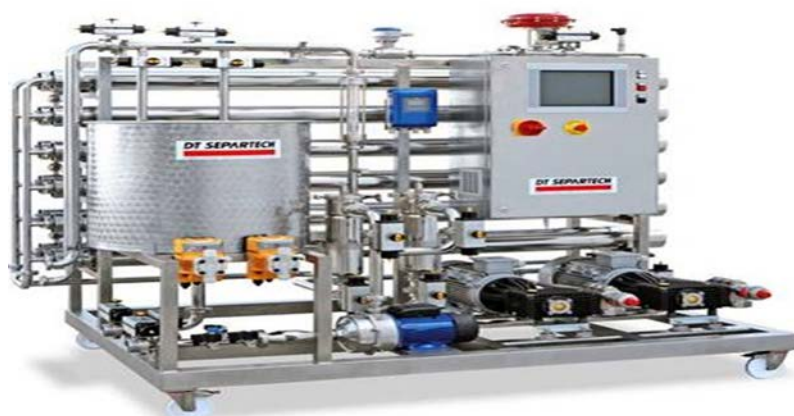
Figura 6. Equipo de ósmosis inversa para mostos
