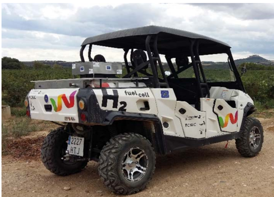
Figura 5. Prototipo de vehículo todo terreno eléctrico alimentado por pila de combustible de hidrógeno
