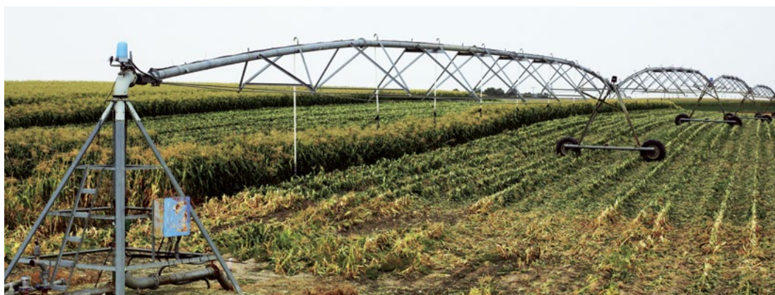
Foto 4. Los modernos sistemas de riego permiten variar la dosis en cada sector y en cada boquilla, según las necesidades hídricas registradas por sensores en suelo o a bordo de drones.
