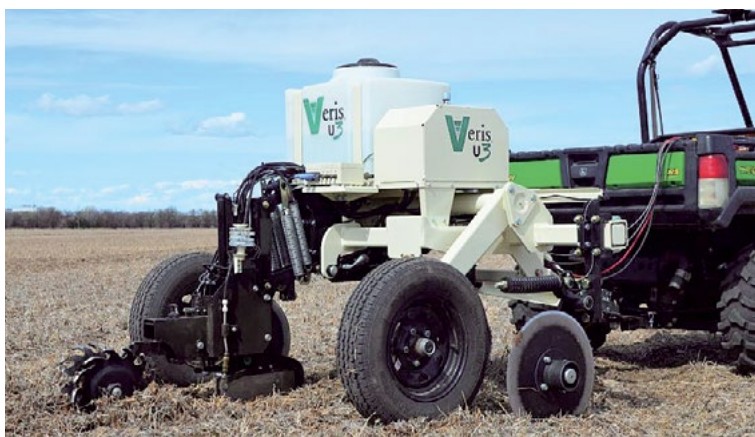
Foto 3. Los sensores para la caracterización del suelo ayudan a crear mapas de la variabilidad espacial del suelo, útiles para entender diferencias en la producción dentro de una parcela (fuente: AAMS Ibérica).
