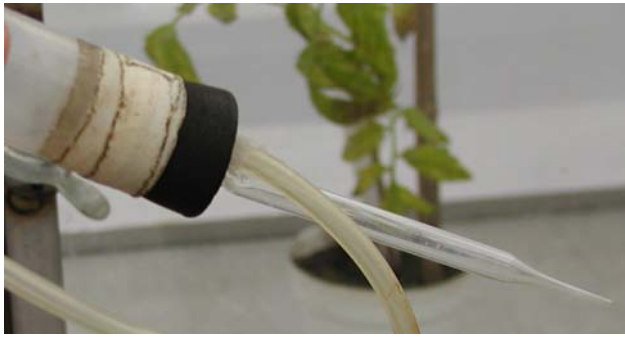
Figura 13. Instrumento para coleccionar las moscas blancas virulíferas que se encuentran en plantas infectadas y transferirlas hacia el material vegetal que se desea inocular.
