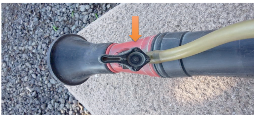
Figura 7.4. Manilla reguladora de paso de líquido desde el estanque hasta la tobera.
