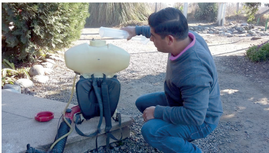
Figura 7.7. Relleno de líquido hasta nivel inicial para determinar volumen utilizado.
